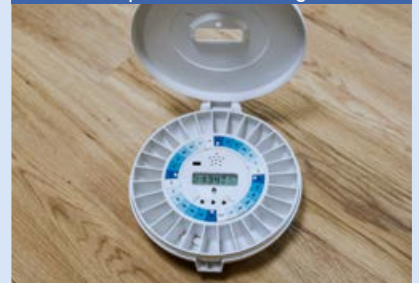
Automatischer Tablettendispenser mit Smartphoneanbindung
