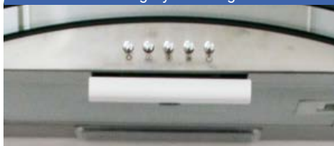
An der Abzugshaube ist ein sensorgestütztes Herdüberwachungssystem angebracht
